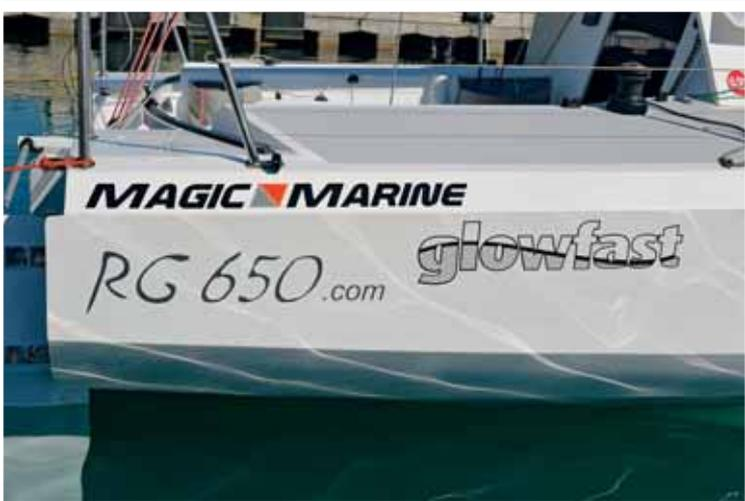
La unión casco-cubierta está pegado con solape de ambas piezas en el flanco inclinado por el exterior de la regala.
