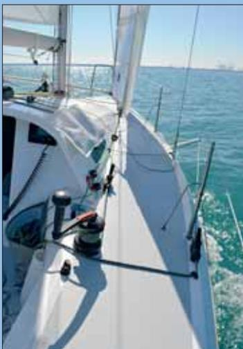
La escota de foque no tiene carrilera ya que circula por los guía cabos con ajustes del barber.
