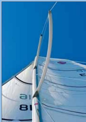
El mástil ZSpars tiene dos pisos de crucetas, con la inferior en arco para poder acercar más la baluma del foque a cruja.
