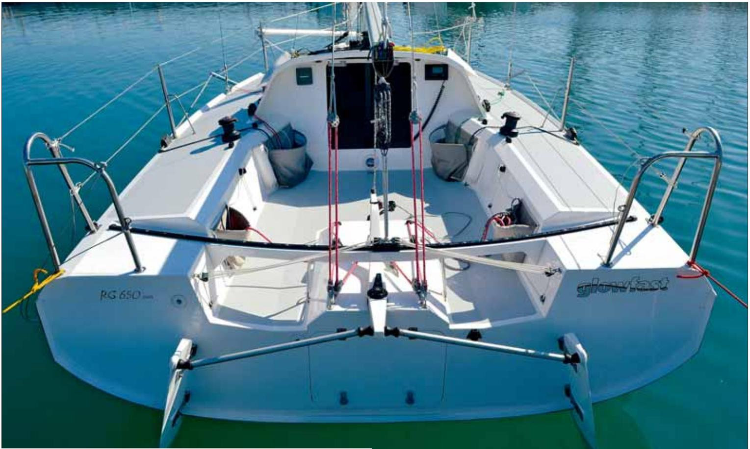
Algunos detalles desde popa: barra de escota curva que cubre casi toda la manga, doble pala de timón, escotilla de emergencia, bancadas planas, cubierta limpia y sobre estructura a popa de la bañera a modo de calapies y anclaje-ajuste burdas.
