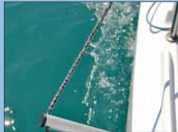
Detalle del outrigger o separador de las brazas de los asimétricos.
